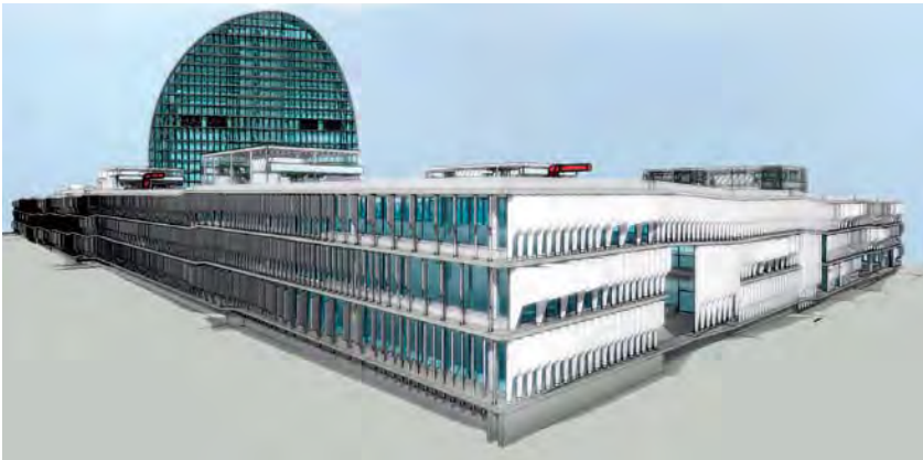
Modelación virtual (BIM) de la nueva sede del BBVA realizado con la herramienta BIM. Virtual model of new BBVA's headquarters carried out with BIM tool.
