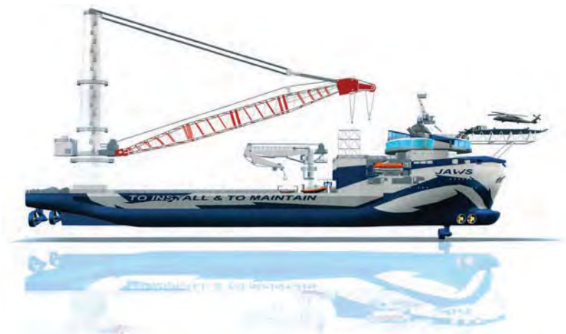
Buque avanzado de instalación y mantenimiento de generadores marinos. Advanced vessel for installing and maintaining offshore wind generators.
