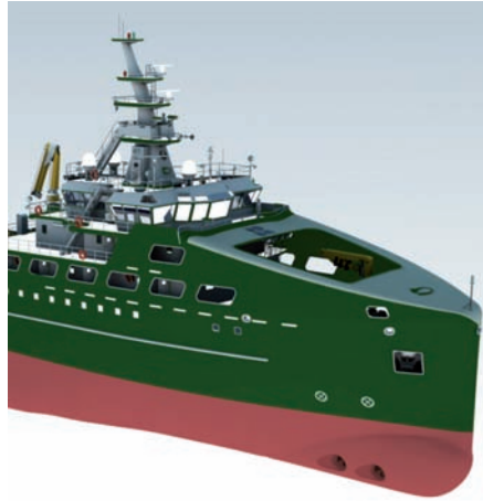
> Diseño de la proa y bulbo del cerquero.
