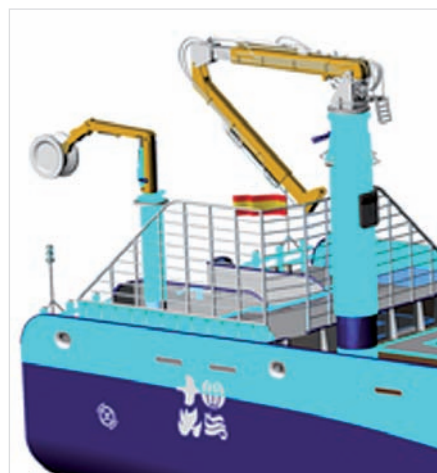
> Espacio optimizado a popa para facilitar la automatización en la estiba de redes, despejada al prescindirse de la panga.
