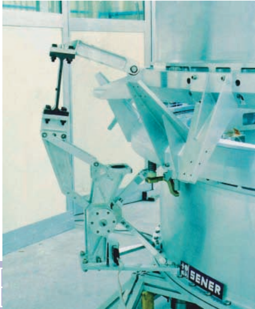
Sistema de atraque y amarre para vehículos espaciales realizados para el módulo europeo Columbus de la Estación Espacial Internacional
